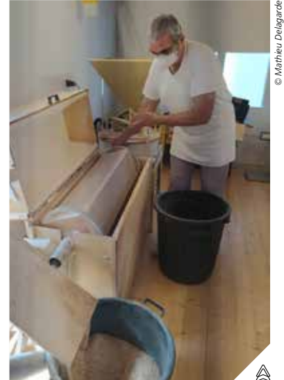
A l'étage du fournil, le couple de paysans-meuniers-boulangers a installé un moulin à meule de pierre, pour fabriquer la farine
