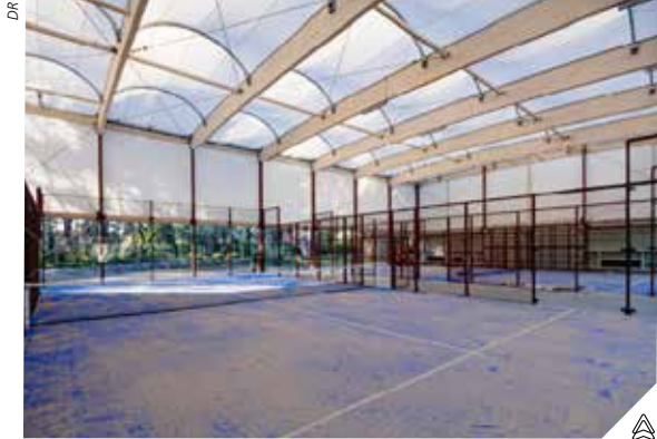
Perspective intérieure : un bâtiment qui garde l'esprit des sports de sable, avec un bardage bois et une membrane textile PVC blanche, laissant passer la lumière naturelle.
